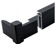
Diese aus Vollaluminium bestehende Rahmenvariante sorgt für maximale Stabilität und Schutz vor Materialermüdung. Die abgerundeten Eckenelemente sorgen für eine höhere Verwindungssteifigkeit und Wasserdichtigkeit in den kritischen, materialschwächeren Eckbereichen. Anders als bei Eckverbindungen über Gehrungsschnitte oder Verschraubungen gewährleisten die WINAICO-Eckenelemente den bestmöglichen Spannungsübertrag zwischen den einzelnen Rahmenteilen.
